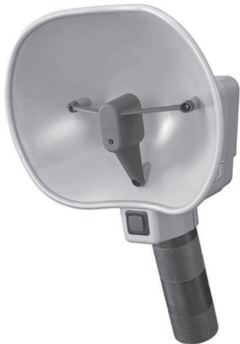
写真3 コロナ放電チェッカー「MK-720」の外観 Photo 3 Photo of corona discharge checker "MK-720"
